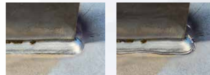
Avant / après: Le traitement HiFIT permet d'augmenter la résistance à la fatigue des soudures entre 80 à 100%!
